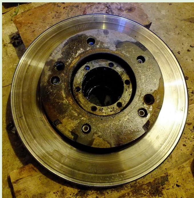
6. Далее очищаем внутренности ступицы от старой смазки. Набиваем новую. Ставим ступицу на ось, ставим и регулируем подшипники.
